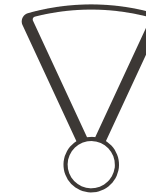
Tấm ngồi nhôm ép đùn Extruded aluminum Seat section
